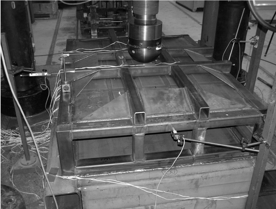
Experimentell modell av sidobordläggningsstruktur
